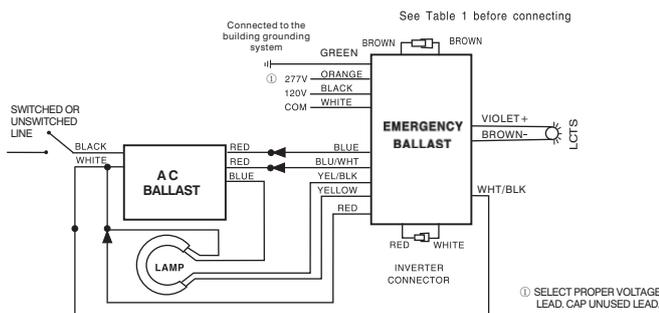
**L. TWO (2) LAMP CIRCLINE RAPID START BALLAST**
