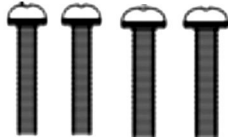
C. (2) #6-32 x 7/8 in. and (2) #8-32 x 3/4 in. junction box screws (use the size that fits your junction box) (2) Vis #6-32 x 7/8 et (2) #8-32 x 3/4 pour boîte de jonction (utiliser la taille adaptée à votre boîte de jonction) (2) Tornillos #6-32 x 7/8 pulg. y (2) tornillos #8-32 x 3/4 pulg. para montaje de la caja de conexión (utilice el tamaño que mejor se adecua a su caja de conexión)
