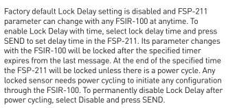
Range: 10 min - 240 min Increments: 1 min
